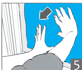
5 usuń warstwę ochronną i wypoźycjonuj folię na bardzo mokrej szybie. Jeśli szyba będzie sucha, folii nie będzie można odpowiednio ustawić
